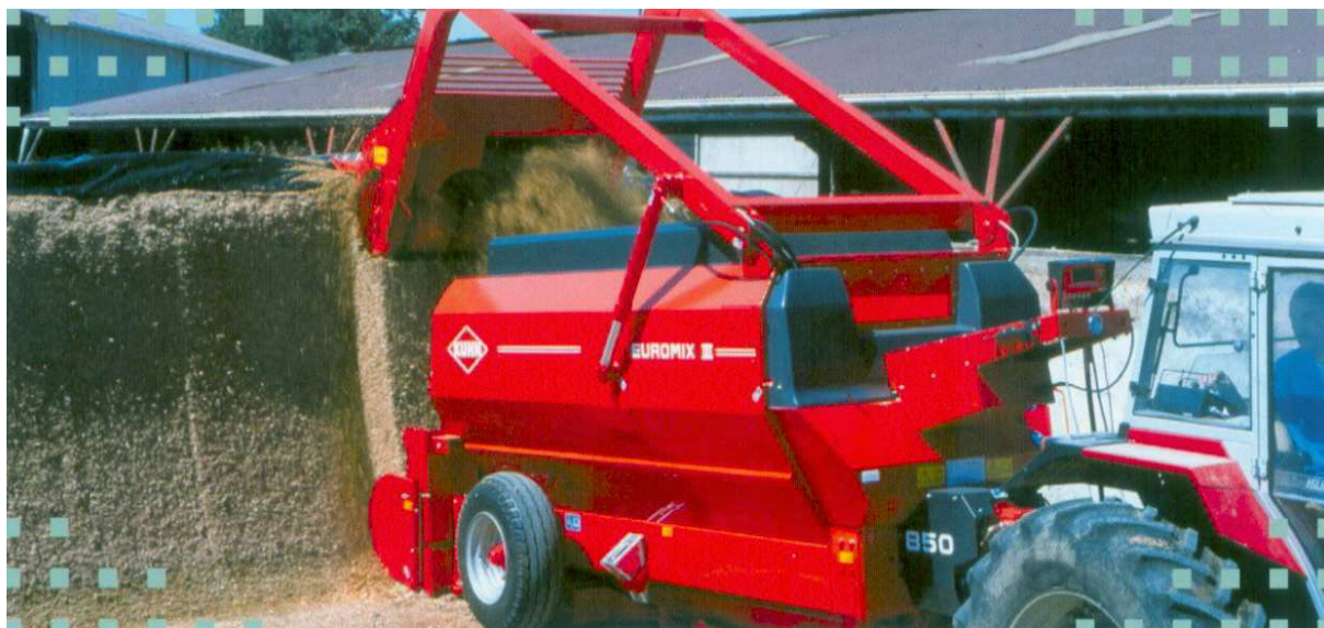
Рис. 7. Прицепной транспортировщик-смеситель-раздатчик кормов с фрезерным погрузчиком
