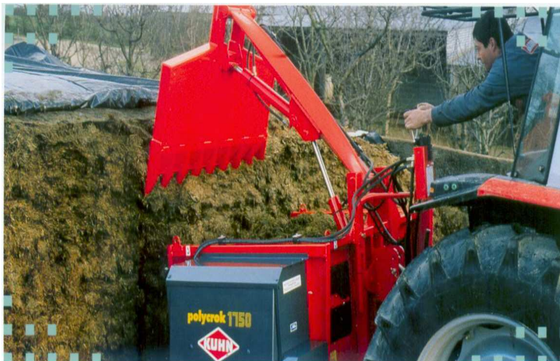
Фото 2. Выемка силоса из траншеи вертикальными слоями
