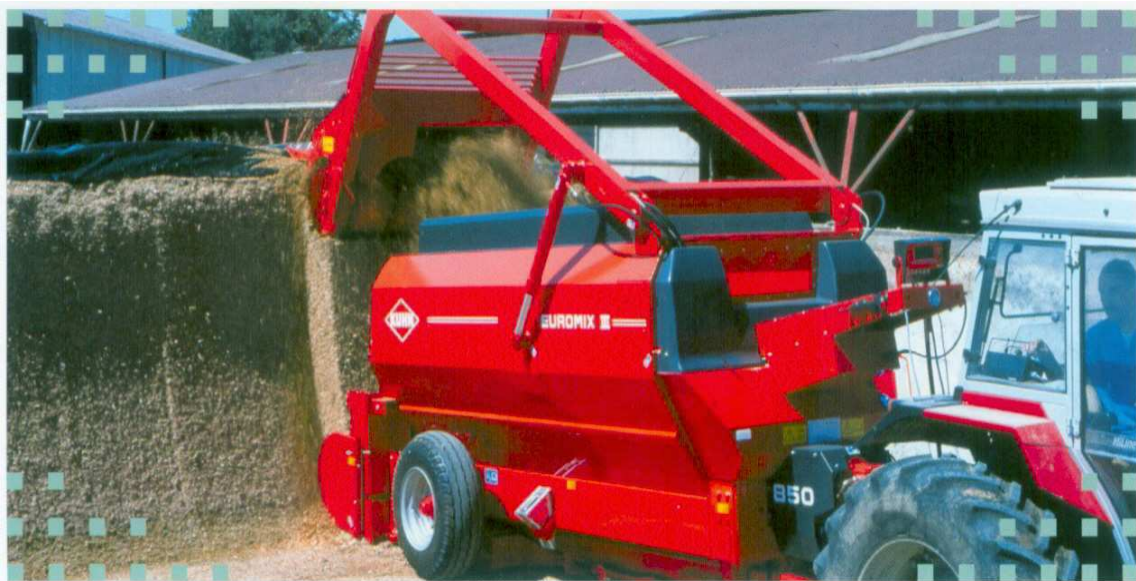
Фото 3. Прицепной транспортировщик–смеситель–раздатчик кормов с фрезерным погрузчиком
