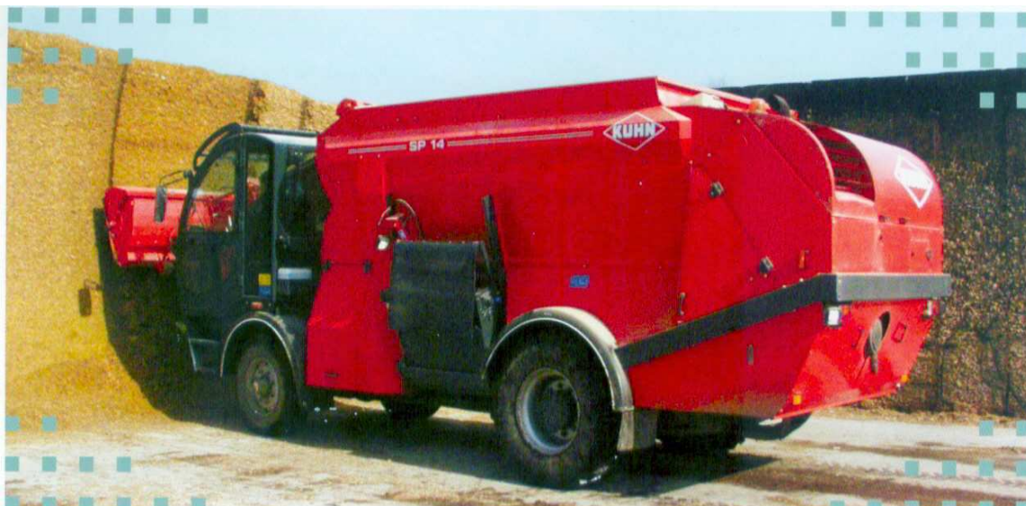
Фото 4. Самоходный транспортировщик–смеситель–раздатчик кормов с фрезерным погрузчиком
